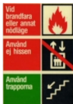
Bild 5.1 Skylt vid hiss som ej ska användas vid utrymning
