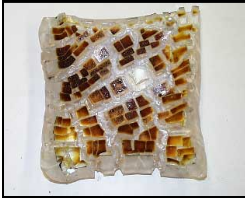
Bild 2.8.1. Provmaterial från Viggen utsatt för 600°C.
