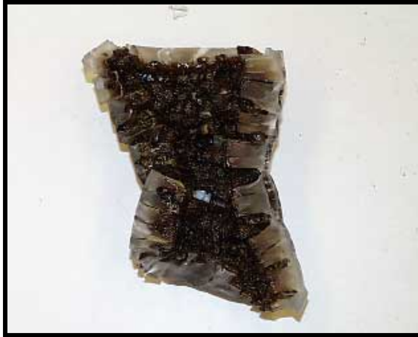
Bild 2.10.1. Provmaterial från Viggen utsatt för 825°C.
