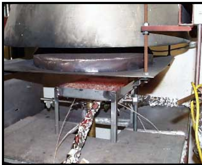
Bild 2.3.1. Försök i konkalorimeter med provmaterial från Gripen
