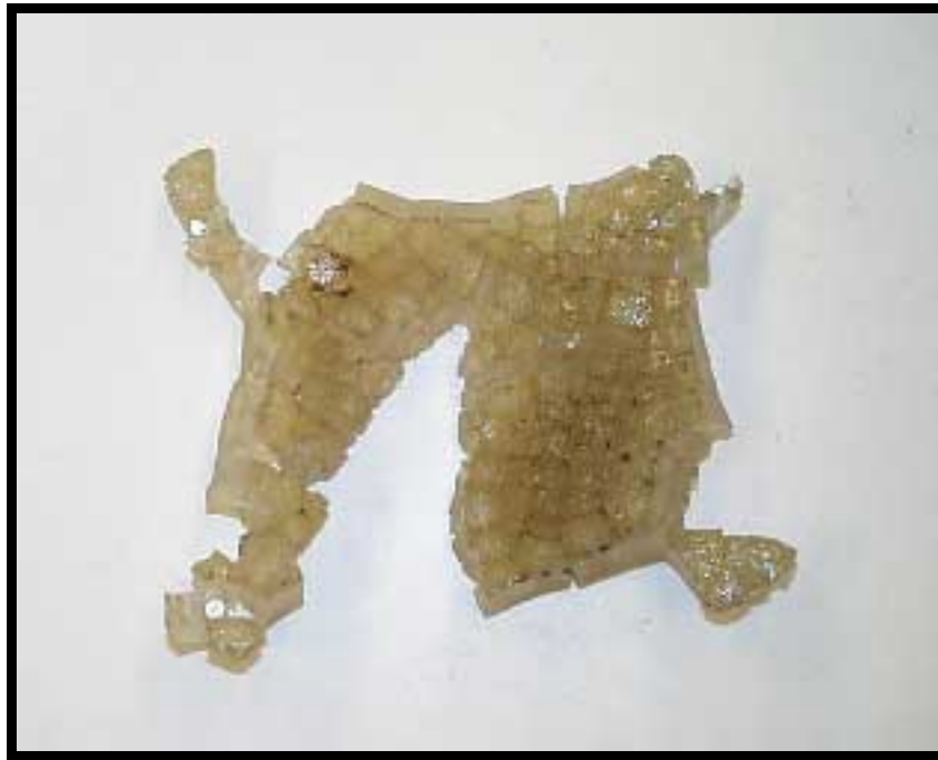
Bild 2.6.1. Provmaterial från Gripen utsatt för 825 °C.
