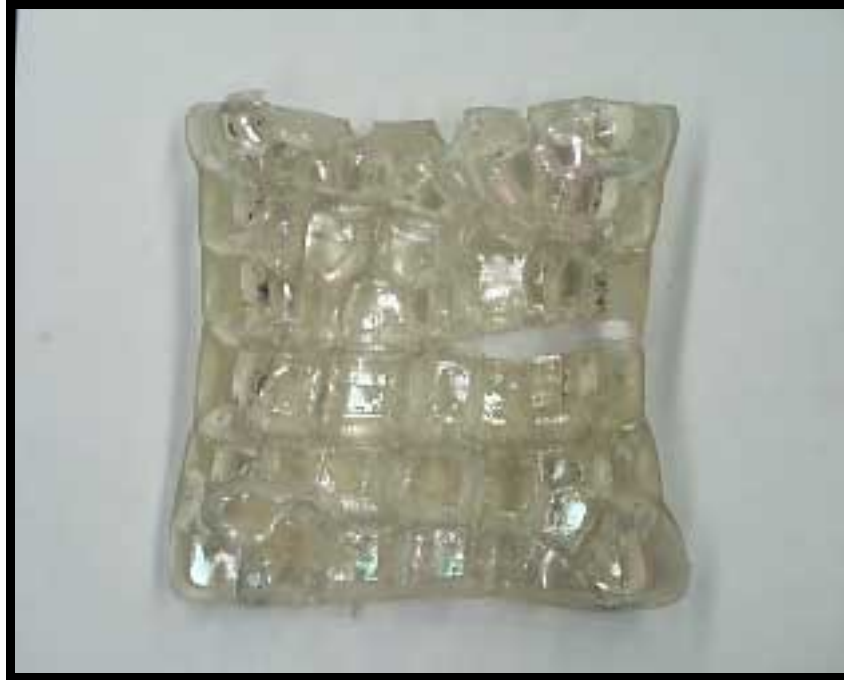
Bild 2.4.1. Provmaterial från Gripfen utsatt för 600°C.
