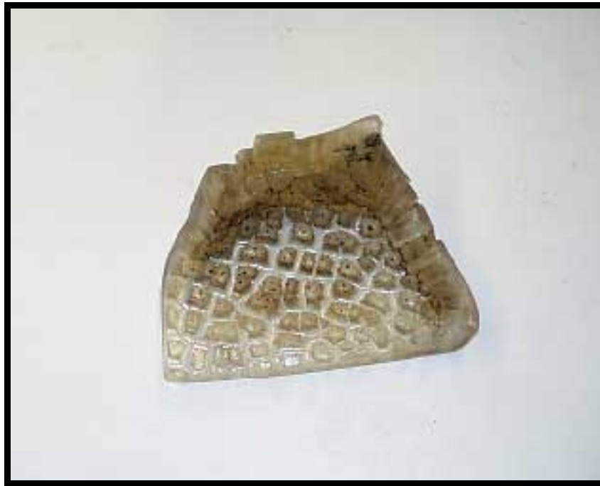
Bild 2.7.1. Provmaterial från Gripen utsatt för 900°C.
