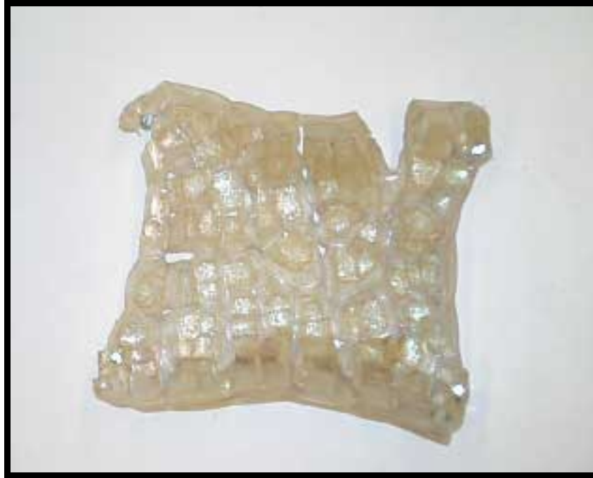
Bild 2.5.1. Provmaterial från Gripen utsatt för 750°C.
