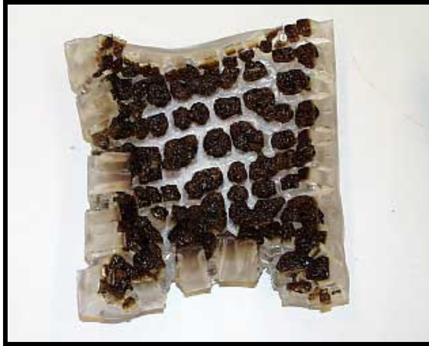
Bild 2.9.1. Provmaterial från Viggen utsatt för 750°C.
