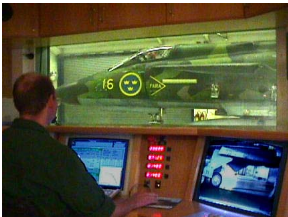
bild 3: Övervakning av motorprovning av Viggen från kontrollrummet
