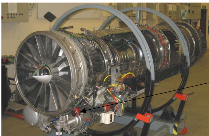
bild 7: Turbojetmotorn RM 12 med utmärkning av bränsleledningen som förser motorn med bränsle.
