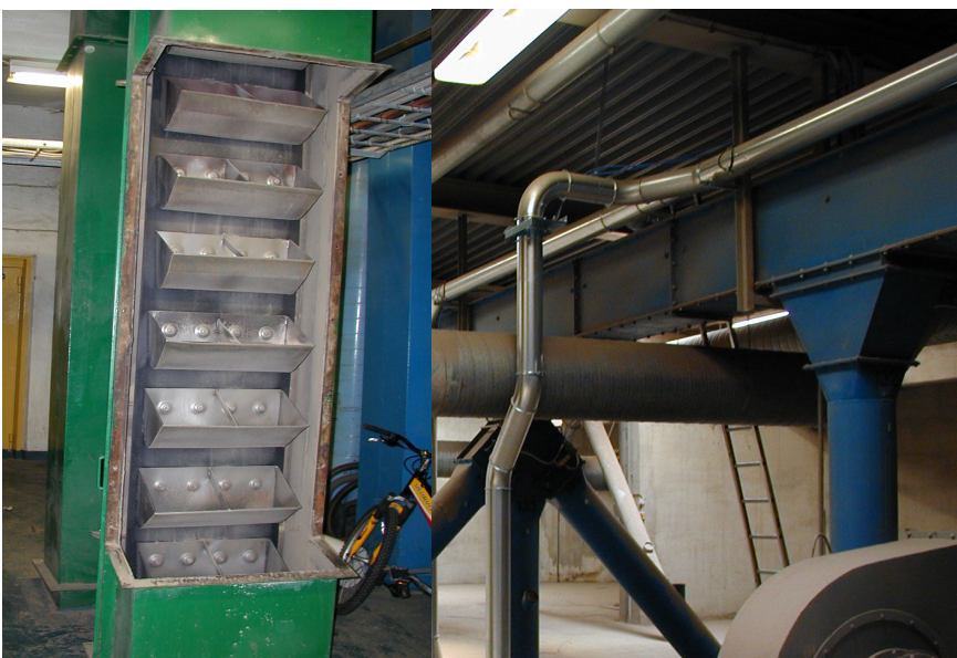
Figur 2.4 Transportsystem i form av elevator och transportör
