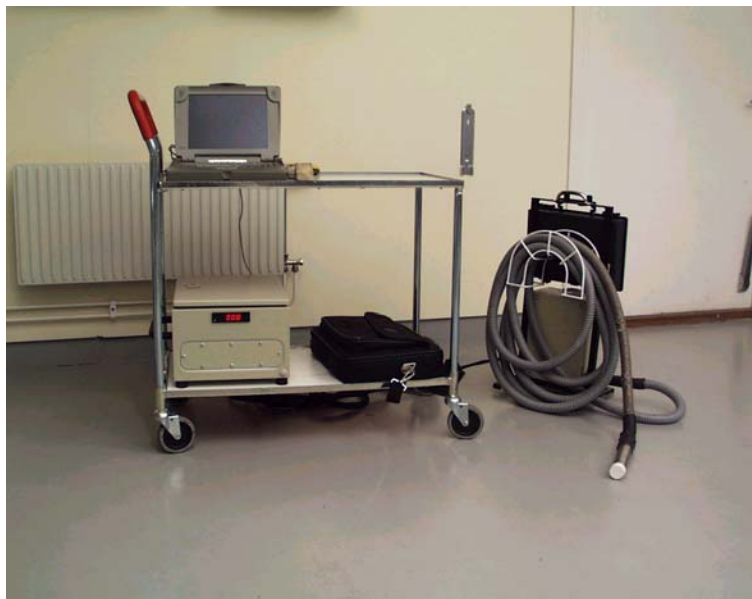
Bild 2.7. Strålningsmätaren med huvudenheten på vagnen och vattenpumpen med kylslang till höger. Den mantlade slangen med mätarens öga i förgrunden.
