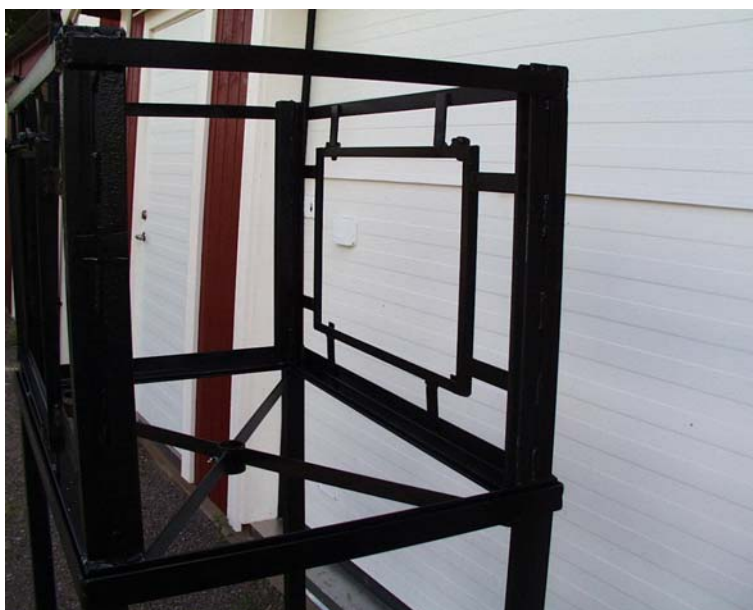
Bild A1.3 Ramen i sin slutgiltiga konstruktion. Här placerad på sin vagn som har tillverkats för att underlätta handhavandet av modellen.
