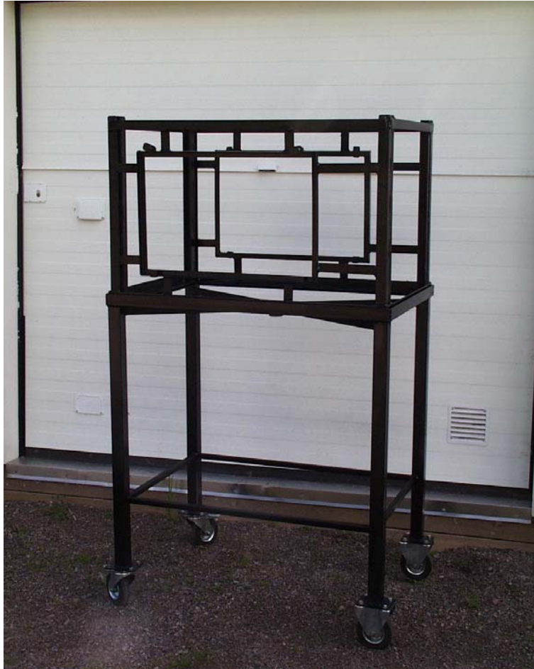
Bild 4.3 Ny konstruktion med ram för infästning av siktskiva. Dessutom tillverkades en vagn för att underlätta förflyttning av modellen. Fäste för strålningsmätaren finns också på vagnen. Möjlighet finns att montera siktskivan på båda långsidorna.
