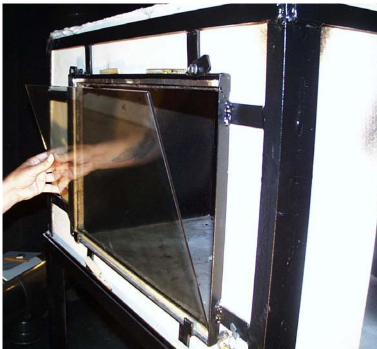
Bild 4.5 Siktskivan ställs på plats i sin ram.
