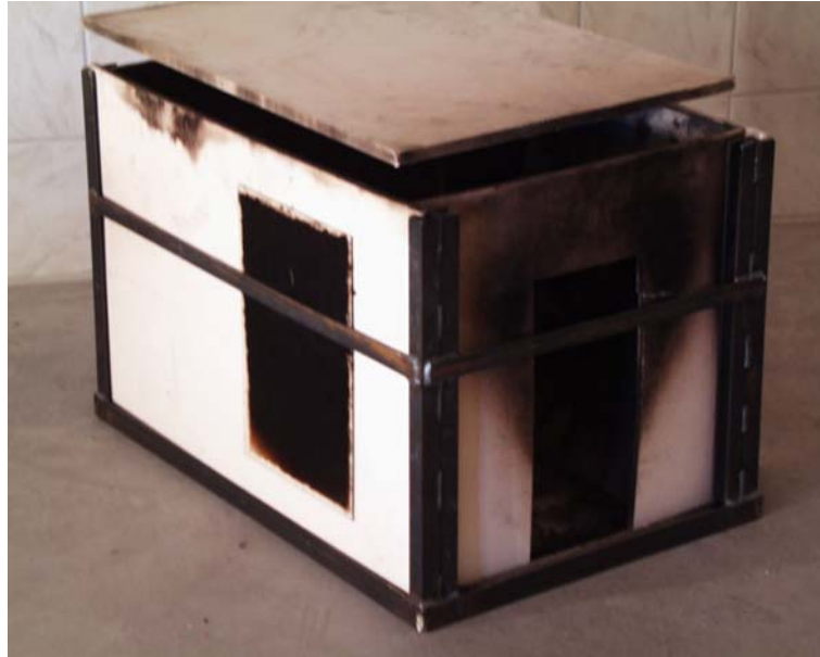
Bild 4.12 Utformning av modellen med liten siktskiva.
