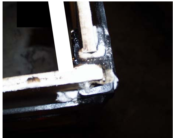
Bild 4.19 Här visas principen över hur kortsidan ställdes i de första försöken (vitt fält). Notera att kortsidan inte står i någon U-profil utan innanför densamma. Inga stålytor exponeras inne i modellen.
