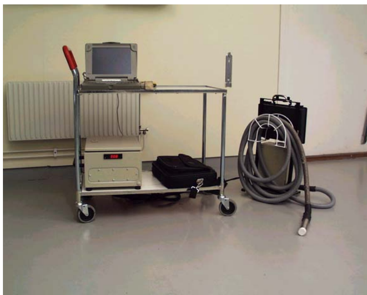
Bild C.1 . Strålningsmätaren med huvudenhet på vagnen samt vattenpump med kylslang till höger.
