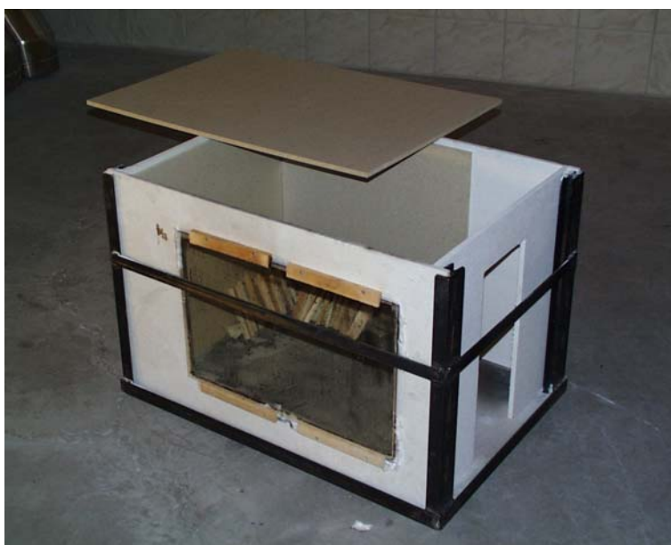
Bild 4.14 Laddning med spånskivor i hörn samt tak. Initialbranden placeras liksom tidigare i hörnet.
