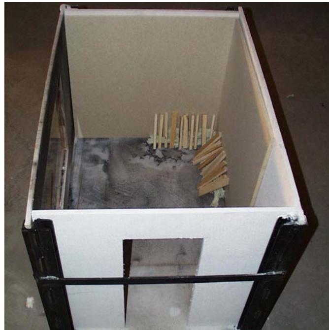
Bild 4.9 Laddning med spånskivor i hörn, här 60+60 cm.
