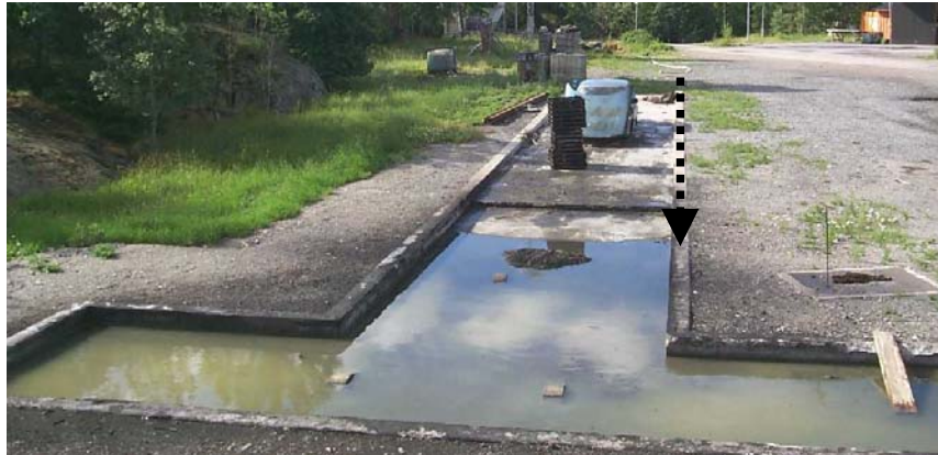
Bild 5. Brandplattan där man i huvudsak eldar diesel.. Inritad pil visar åt vilket håll plattan lutar.
