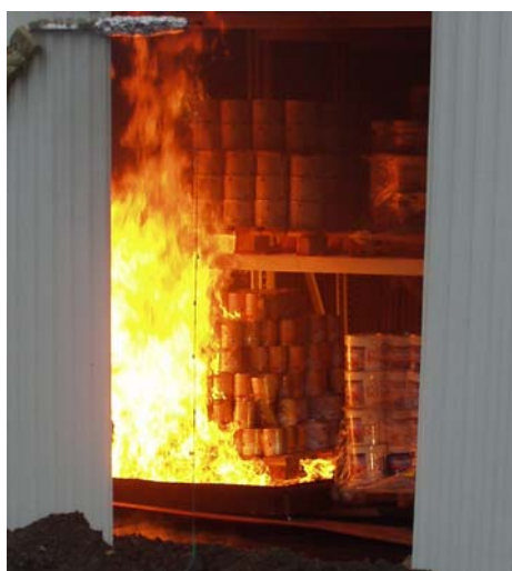
Figur A6: Flamhöjden uppgår till ca 1.5 m efter 12 s.
