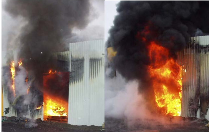
Figur A10: Direkt före och direkt efter kollaps av pallställning.
