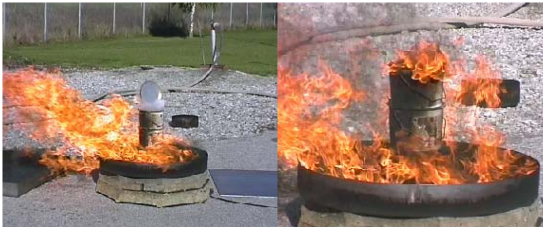
Figur B3: Efter ca 1.5 minut flyger locket av på den översta burken.
