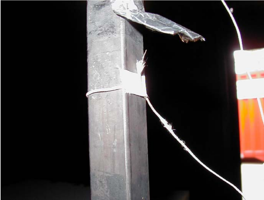
Figur 3.3. Närbild på termoelement med kåpa.
