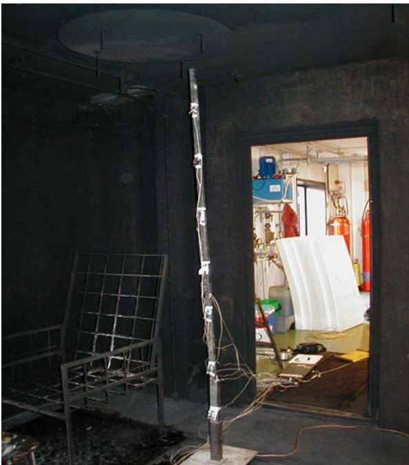
Figur 3.2. Foto på ett helt termoelementträd
