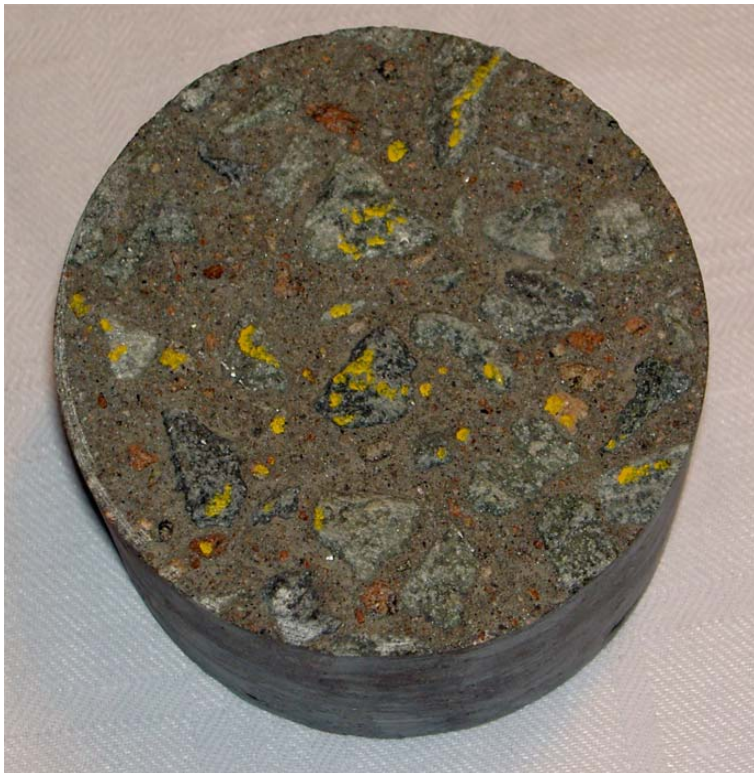
Bild 8. Borrprov betong (diameter 95 mm)
