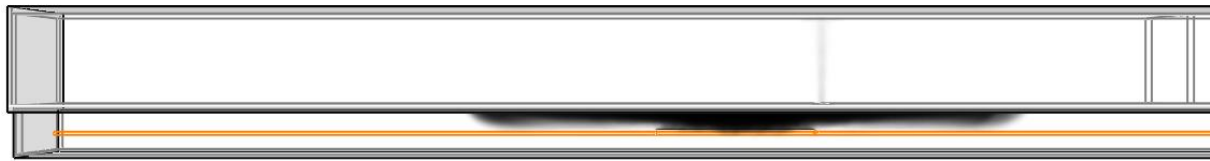
Figur 6.22 Brandgasspridning till närmaste brandcell sker inom 60 s.
