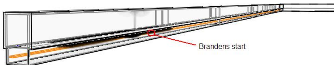
Figur 6.19 Inom 60 s börjar brandgasspridning ske till ovanliggande brandcell.
