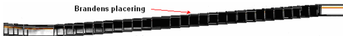
Figur 6.9 Brandgasernas utbredning efter 13 min.
