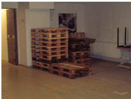
Figur 6.3 Pallstapel som antas som brännbart material.
