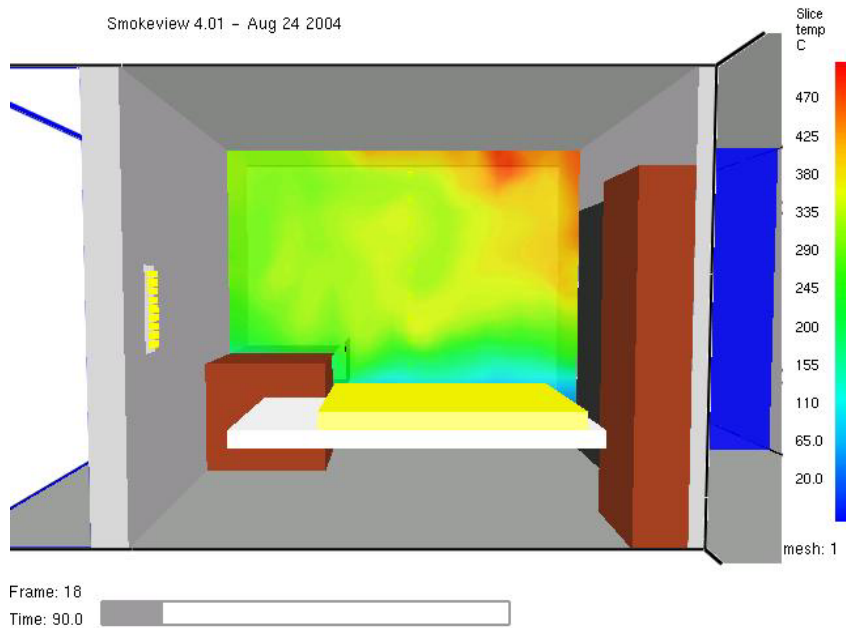
Figur 5 Temperaturprofil i cellen efter 90 sekunder.
