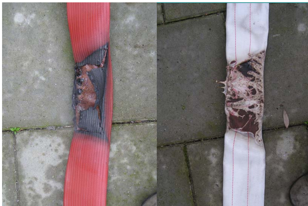
Figur 5:4 Resultat av värmestrålning mot tom brandslang ( 30 \text{ kW/m}^2 )
