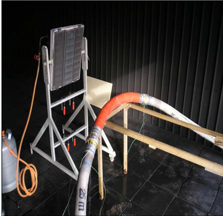
Figur E:2. Experimentuppställning som visar termoelementens placering
