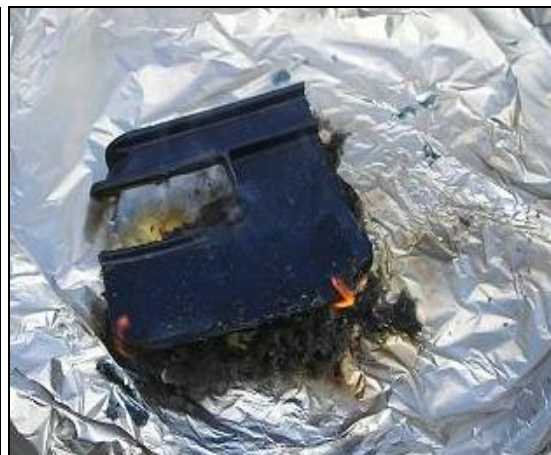
Figur 14. Det upprända pappret antände plasten. (Foto: Dahlqvist J, 2007)
