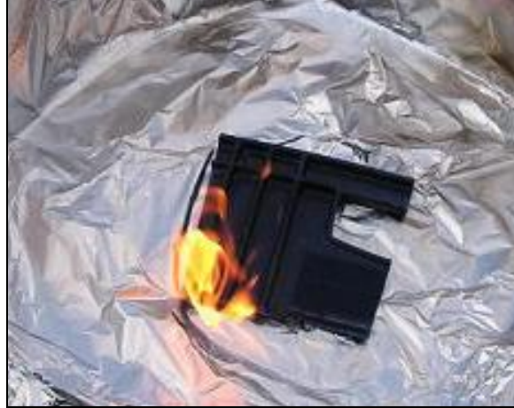
Figur 18. Plasten antänds av heptanet (Foto: Dahlqvist J, 2007)
