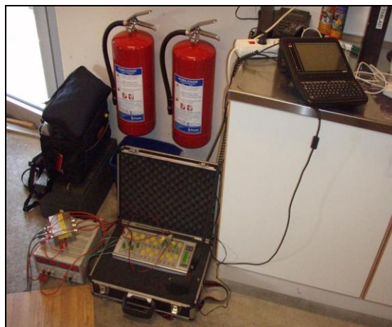
Figur 22. Datorn där mätdata från lastcellerna och termoelementen registreras. (Foto: Dahlqvist J, 2007)
