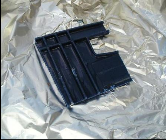
Figur 17. Plasten applicerad med heptan (Foto: Dahlqvist J, 2007)
