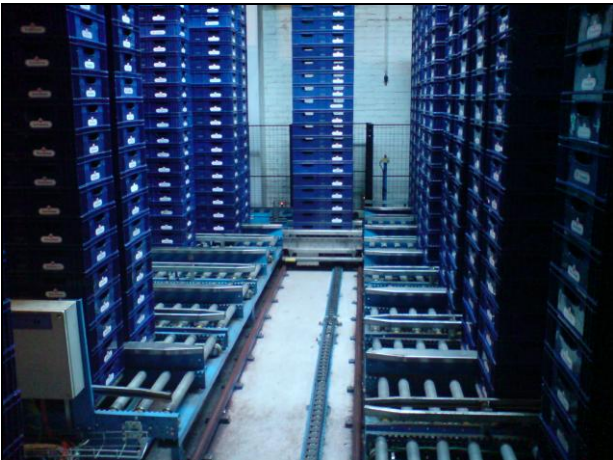
Figur 3. Plastbackarnas konfiguration i backhallen. (Foto: Andersson S, 2007)
