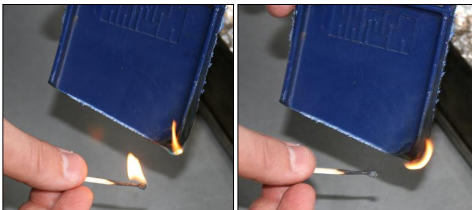
Figur 11 och 12. I bildserien ses tydligt hur tändstickan antänder plastbiten. (Foto: Dahlqvist J, 2007)
