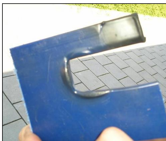
Figur 16. Resultatet från heptanbranden. (Foto: Dahlqvist J, 2007)
