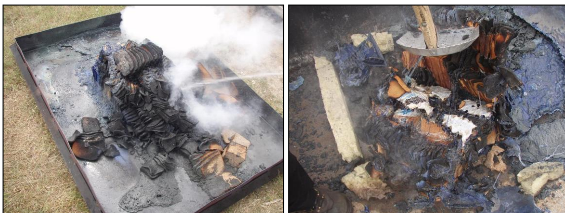
Figur 29 och 30. Bröden efter försöket. Observera att bröden är i princip oförändrade under det översta svarta kollagret. (Foto: Dahlqvist J, 2007)
