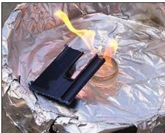
Figur 15 Plasten över heptanbrand. (Foto: Dahlqvist J, 2007)
