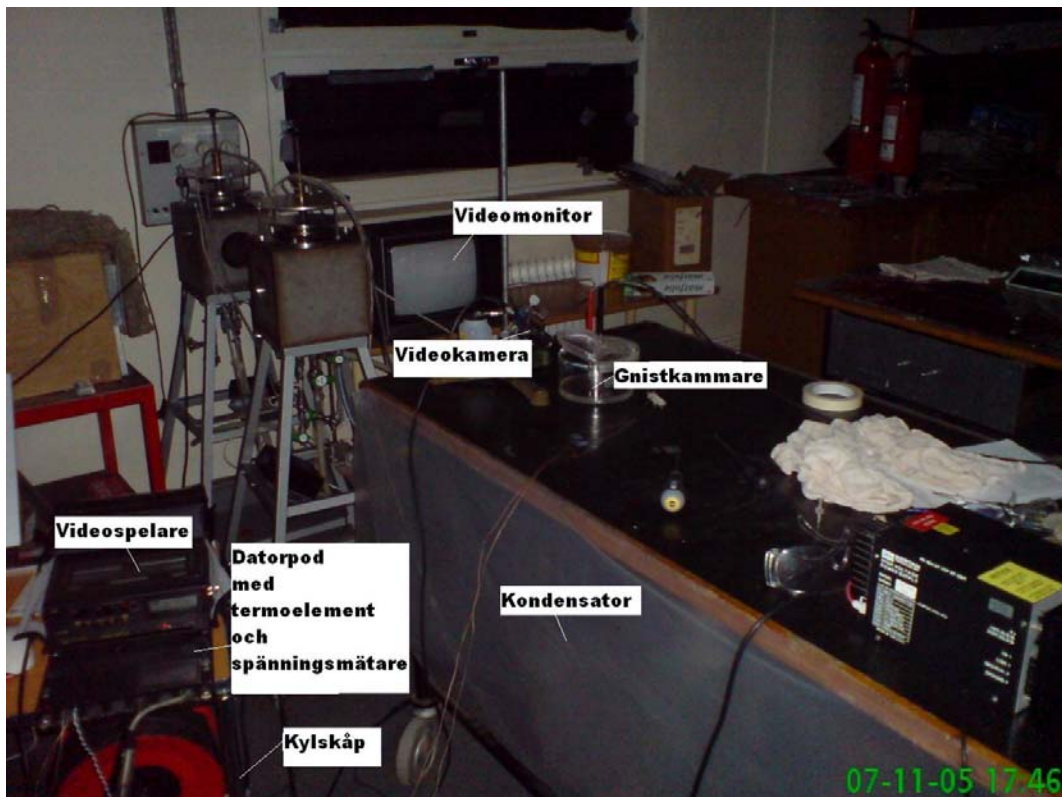
Bild 8. Försökuppställning vid mätning av flampunkt.
