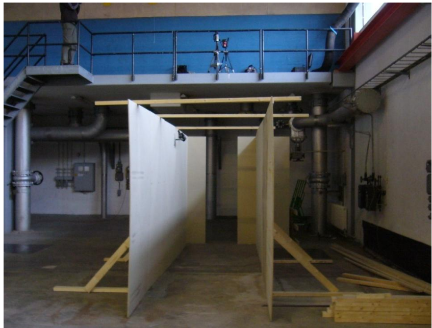
Figur 1, Banans konstruktion samt placering av kameror.
