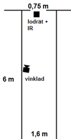
Figur 2, Mått på banan samt placering av vinklad kamera, lodrät kamera och IRkamera.
