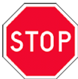
Figur 1. STOP-skylten har utformats med redundans genom sin unika form, unika färg och texten STOP.
