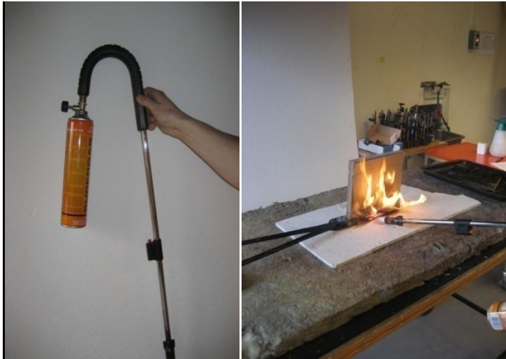
Bild C. 1: Handgasbrännaren samt försöksupställningen del 1.
