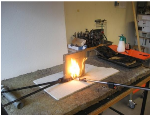
Bild C.9: Försökupställningen del 1 samt antändningsprocedur
