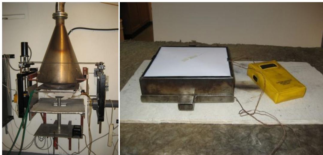
Bild C. 2: Konkalorimetern och ett monterat prov.
