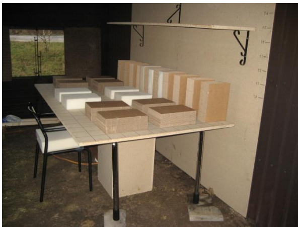
Bild D. 4: Försöksuppställningen i sin helhet från försök 1. På bilden saknas antändningskällan. Luckan som syns på bilden stängdes under försöket.
