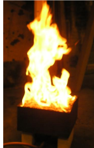
Bild D. 1: Antändningskällan vid kalibrering.
