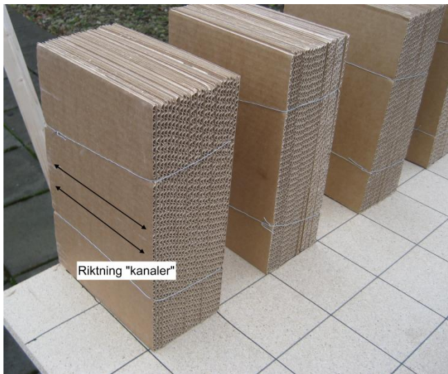
Bild 5. 1: Stående kassetter av wellpapp. Dessa surras med ståltråd för att hållas ihop samt vågprofilen ska vara horisontell med bordsskivan.
