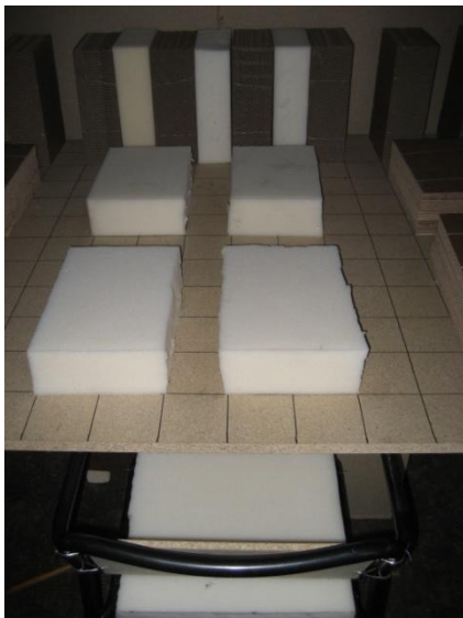
Bild D. 5: Försök 1 sett framifrån. Notera att i detta försök var inte stolen, hurtsen och antändningskällan centrerad.
