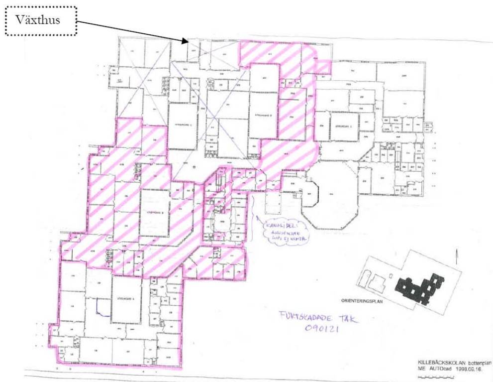
Figur A 9. Fuktskador i tak, kryssade delar är rivna.
