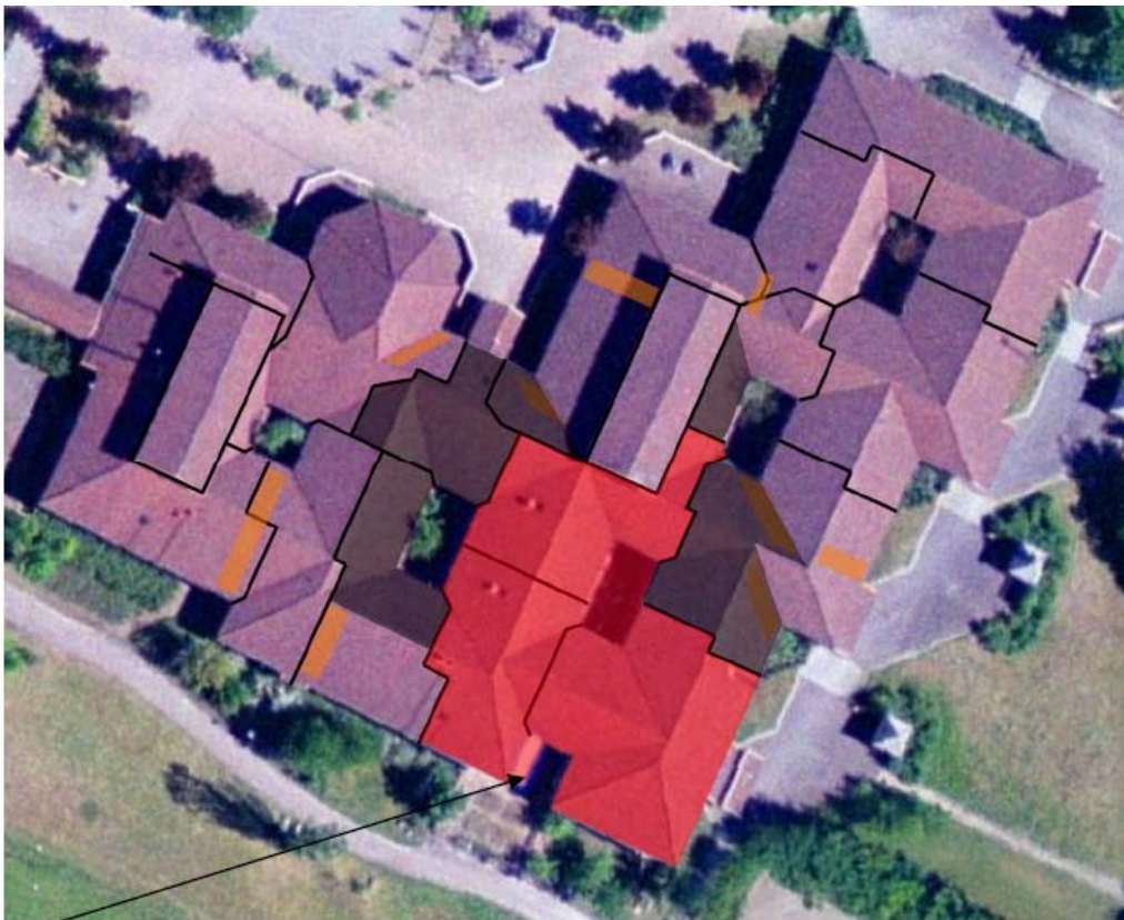
Figur A 2. Röda tak totalskada rivet under brandskedet. Mörkbruna delar kraftigt brandskadat på vinden. Orange fyrkanter håltågning för brandgaser. Svarta linjer ”brandcellsgränser på vinden”.
