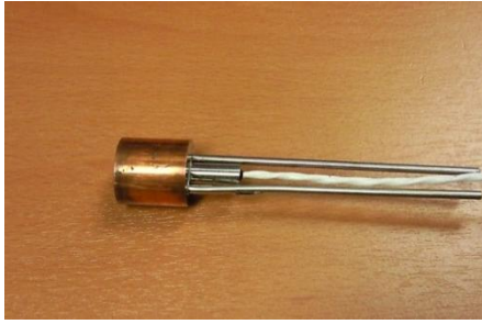
Figur 12 Medtherm för mätning av infallande strålning upp till 50 \text{ kW/m}^2 .
