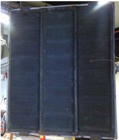
Figur 9 Strålningsalstrarens tredelade panel.
