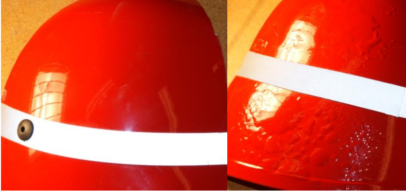
Figur 48 Klarlackat ytskikt där visuell skada först uppvisas i form av bubblor.
