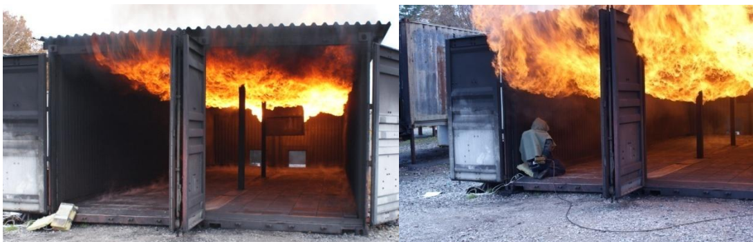
Figur 18 Försöksuppställningar vid strålförarcontainern.
