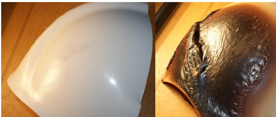
Figur 47 Ytskikt före och efter tjugo minuters exponering mot 20 \text{ kW/m}^2 .
