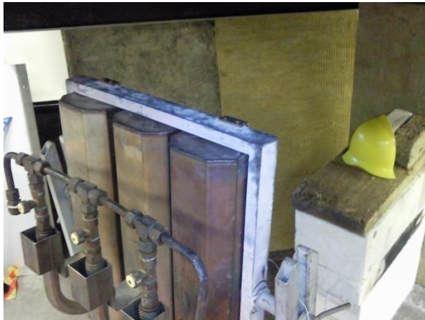
Figur 21 Försöksupställningen med strålningsalstrare, podium och itusågad brandhjälm.
