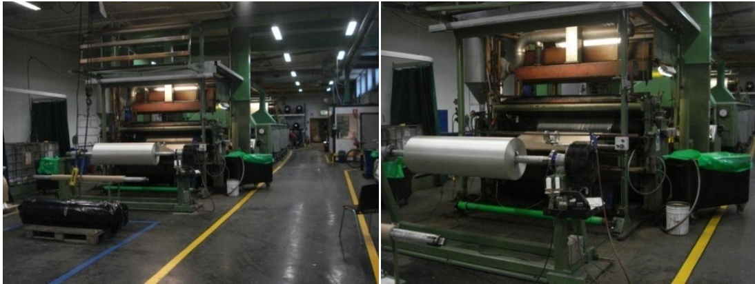
Figur 4.6 Dippmaskinen sedd framifrån (t.v.) och rullupphängningen (t.h.).
