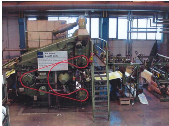
Figur 4.11 En bandvulkningsmaskins princip.
