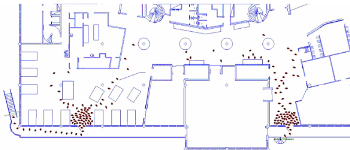
Figur 5.5 Trängsel vid nödutgångar pga. dörrarnas begränsade öppningsmöjligheter
