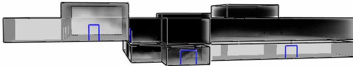
Figur D-2 - Brandgasfyllnad i garderobsscenarioet efter 120 sekunder.
