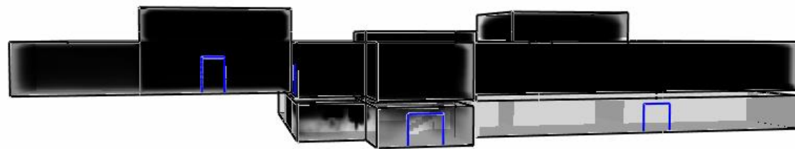
Figur D-4 - Brandgasfyllnad i garderobsscenarioet efter 600 sekunder.
