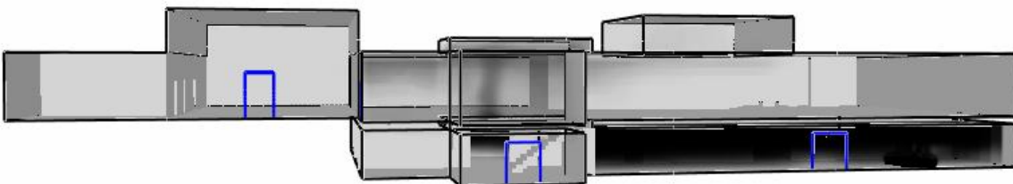
Figur D-13 - Brandgasfyllnad i bodegascenariot efter 240 sekunder.
