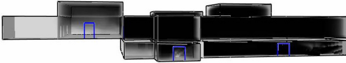
Figur D-15 - Brandgasfyllnad i bodegascenariot efter 600 sekunder.
