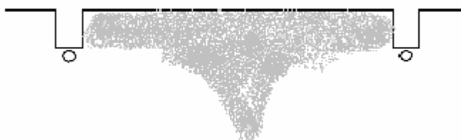
Figur 3 Röken fyller först spalterna innan sprinklern nås
