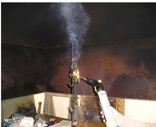
Figur 2 Nätet utsätts för en flamma
