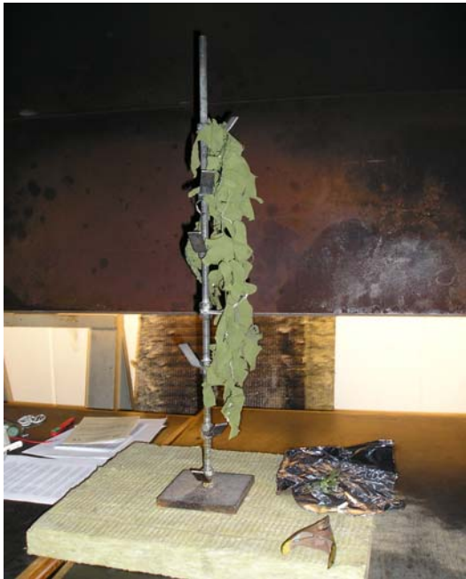
Figur 1 Försöksuppställning vid brännbarhetsförsök
