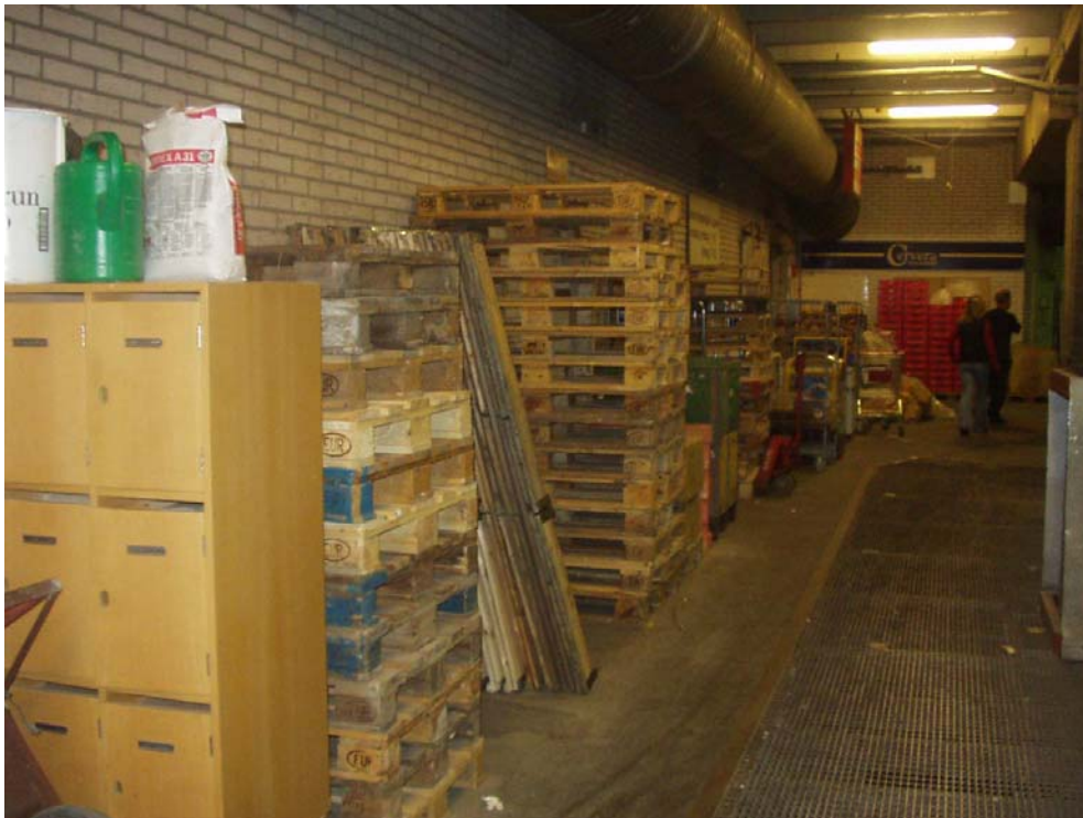
Bild 7.1: Hög brandbelastning vid lastkaj.
