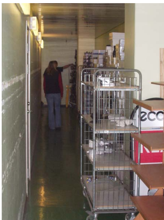
Bild 5.2: Trångt i utrymningsgångarna samt hög brandbelastning.
