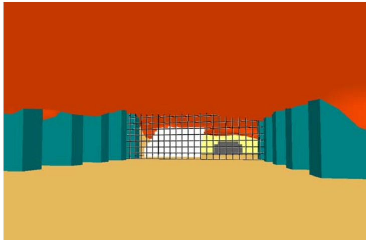
Bild 6.12: Bilden åskådliggör den kritiska siktbarheten 5 m i brandrummet vid tiden 200 s. Varje ruta är 0,25 m hög.
