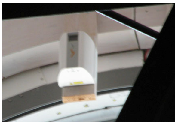
Figur 6.4. Linjedetektorns placering i taket
