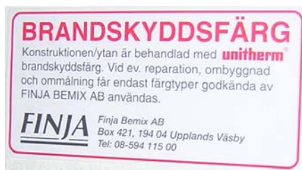
Figur 5.8 Skylt i de brandtekniskt skilda utrymningsvägarna, vilken anger att dessa är målade med brandskyddande färg.
