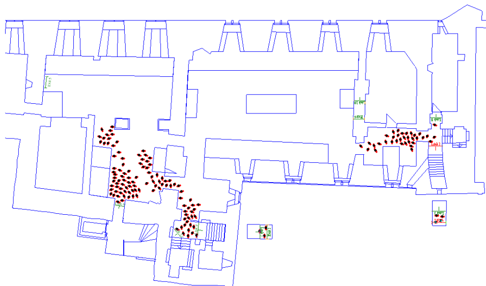
Figur 21 Utrymning av julmarknad: Bild från Simulex visar var stockningar uppstår under utrymningen av Plan 2 under julmarknaden.
