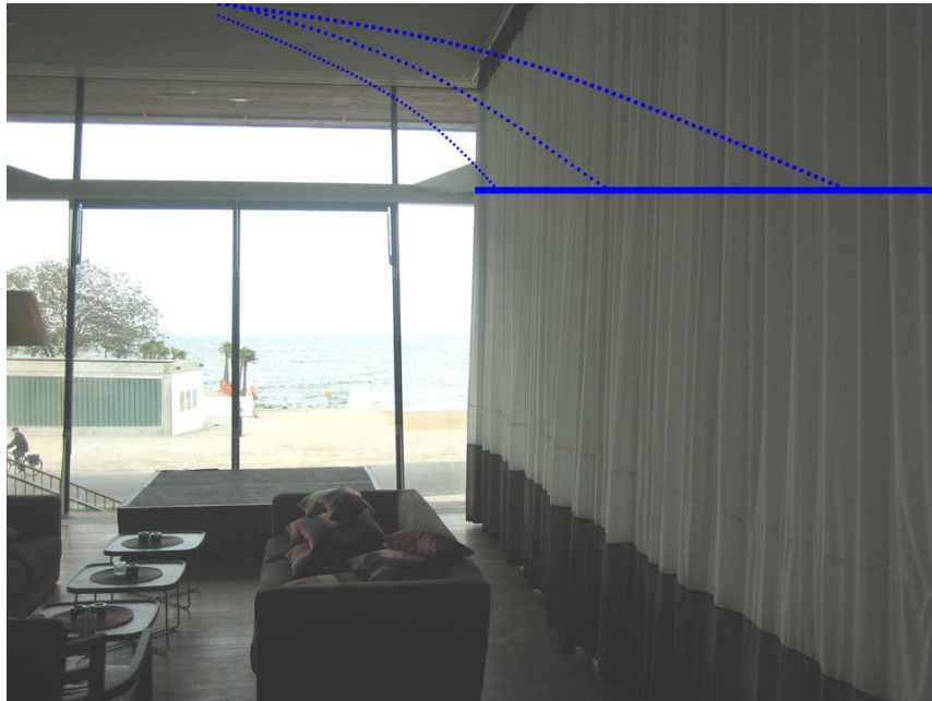
Bild B.1 Sprinklernas uppskattade verkningsområde.
