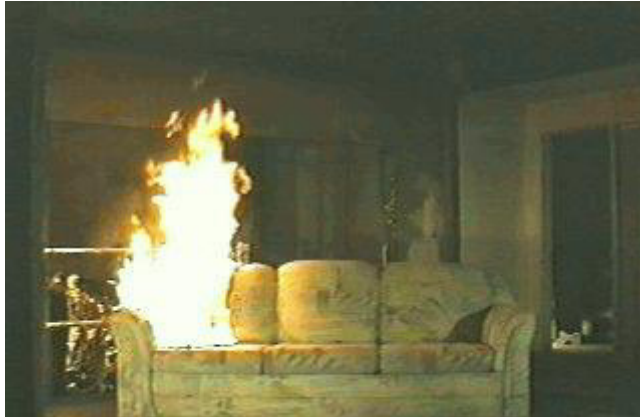
Bild 6.5 Soffa efter ca 120 s. (NIST)
