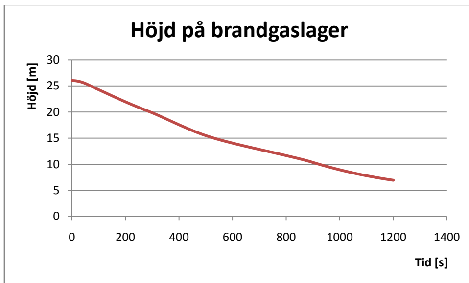
Figur 7.4. Redovisar brandgaslagrets höjd som funktion av tiden vid simulering av scenbranden i CFAST.
