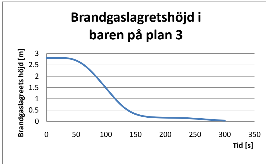
Figur L3. Brandgaslagrets höjd över golvet i baren på plan 3 som funktion av tiden.
