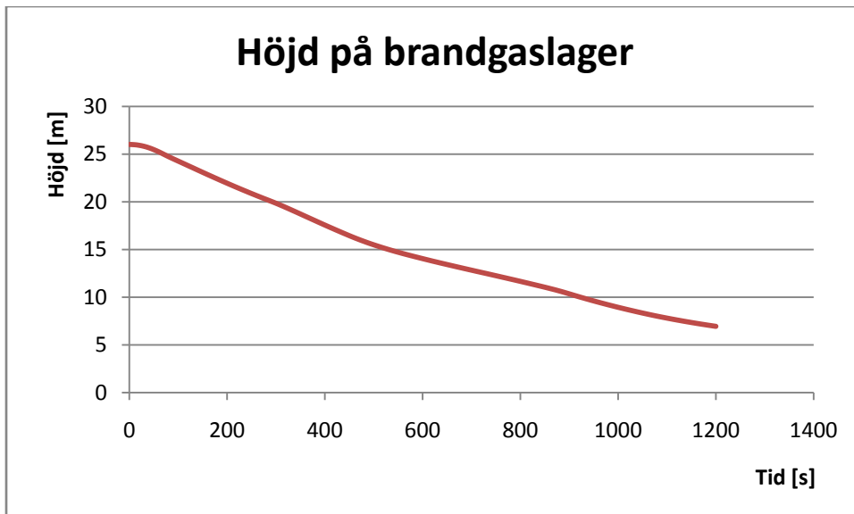
Figur H3. Redovisar brandgaslagrets höjd som funktion av tiden vid simulering av scenbranden i CFAST.
