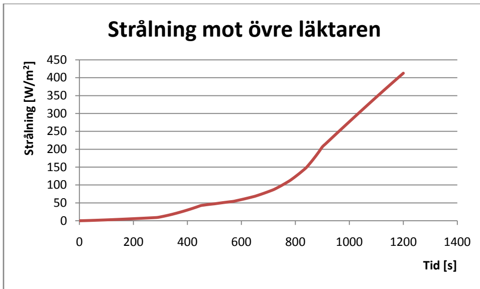
Figur 7.6. Redovisar strålningen mot objekt som befinner sig på den övre läktaren.
