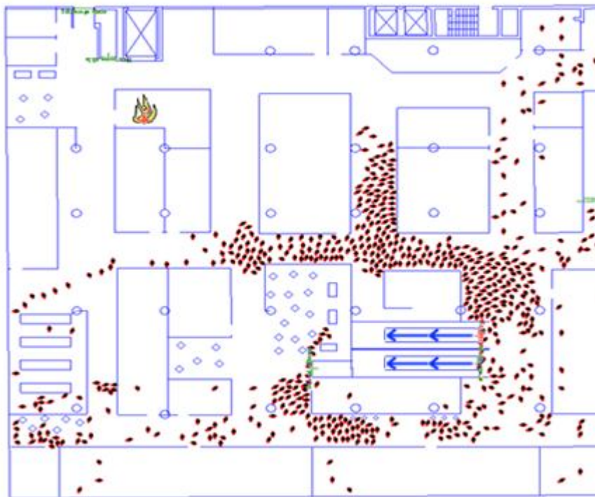
Figur 7.6 Utrymningsituationen efter 3 minuter enligt Simulex
