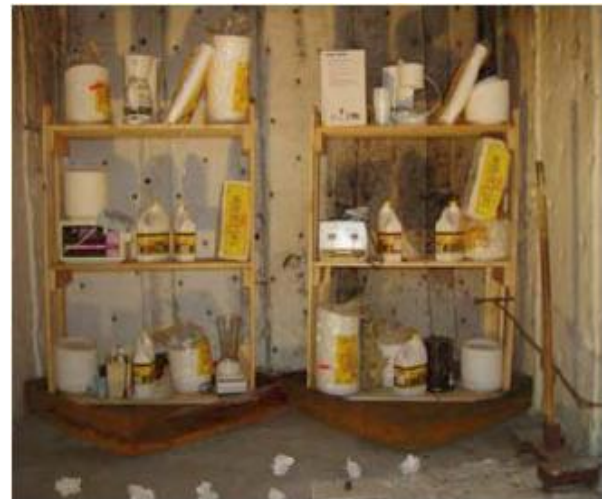
Figur 9.4. Försökupställning gjord av National Research Council. Materialet som eldats antas motsvara det som kan finnas i ett snabbmatskök.
