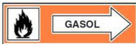
Figur L.0.2. Märkning av gasolledning.
