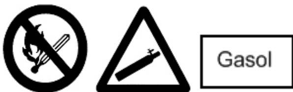
Figur L.0.1. Märkning för skåp där gasflaskor förvaras.
