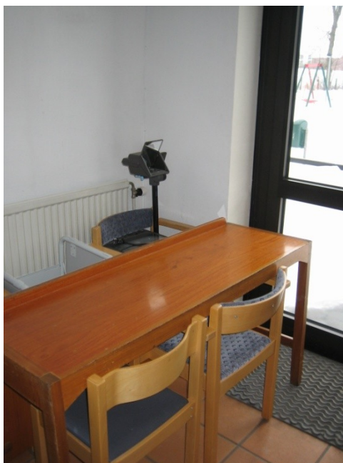
Figur 50: Lös inredning i utrymningsvägen.
