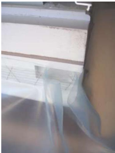
Figur 10 Veckat plastfoliehorn fäst med dubbelhäftande tejp (Wahlgren, 2010)
