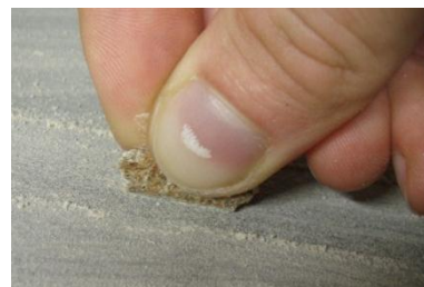
Figur 6. Provberedning. Slipning av pellet i dess längdriktning.
