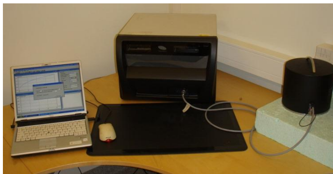
Figur 5. Försökuppställning. Från vänster: PC, TPS-enhet, provhållare med skyddshuv.
