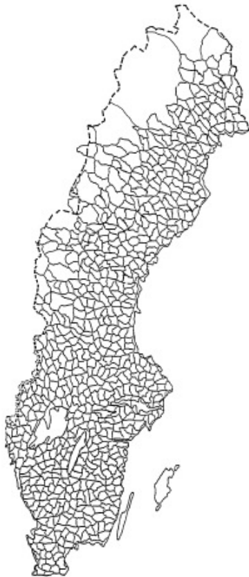
Figur 2.10 Nätet för den tredje nationella precisionsavvägningen, riksavvägningen, som är grunden för RH2000 (Källa Lantmäteriet, 2009). © Lantmäteriverket
