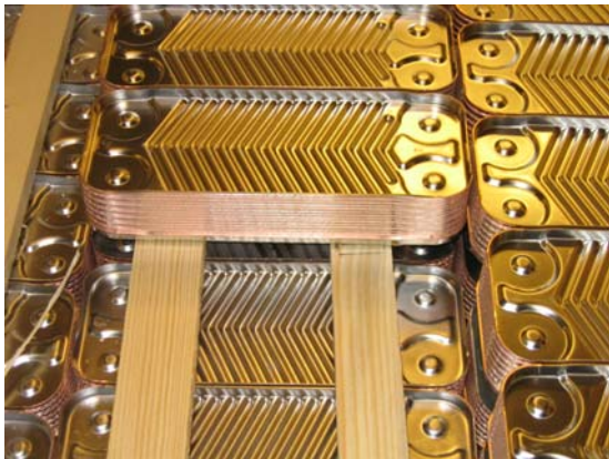
Bild 4-21. Två träreglar fungerar som distans mellan raderna av värmeväxlare.
