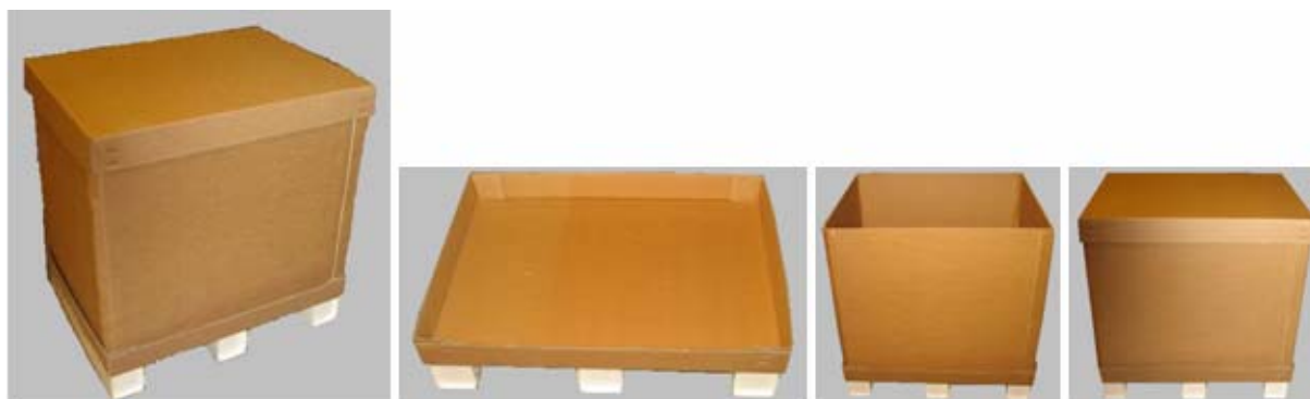
Bild 5-33, 5-34, 5-35 och 5-36. Halvpall med ytteremballage. Vänster bild visar emballage och lastbärare i sin helhet. De tre bilderna till höger visar hur emballaget ska monteras.
