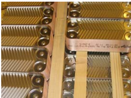
Bild 4-19. Mellan varje rad en träregel i sidled och två i höjded.
