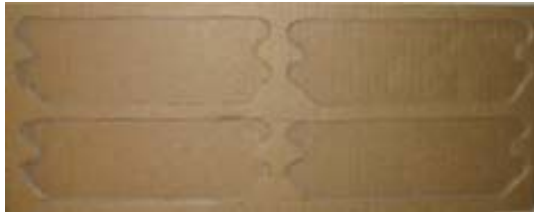
Bild 5-3. Utvecklingssteg 3, utskuren wellpappsskiva limmad på en ren wellpappsskiva.
