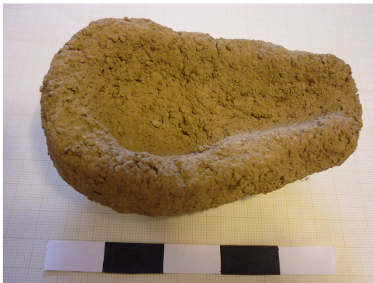
Figur 14: Rekonstruerad degel (nr. 3D) som använts vid experimenten (foto: förf.).
