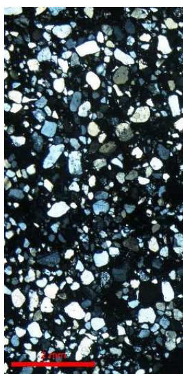
Figur 22: Tunnslip av skärva 2 (inv. nr. 5951) (vänster) använd som förlaga för deglarna 1A & 1B. Tunnslip av de rekonstruerade deglarna 1A (mitten) & 1B (höger). Rekonstruktionerna ser ut att ha en magring som innehåller något större korn än förlagan. Skalstreck: 2 mm (foto: förf.).
