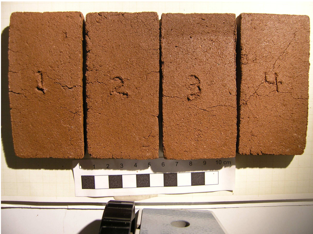
Figur 36: De briketter som svalnat i ugn (höger) resp. i rumstemperatur (vänster). Sprickbildningen på de båda grupperna är mycket lik
