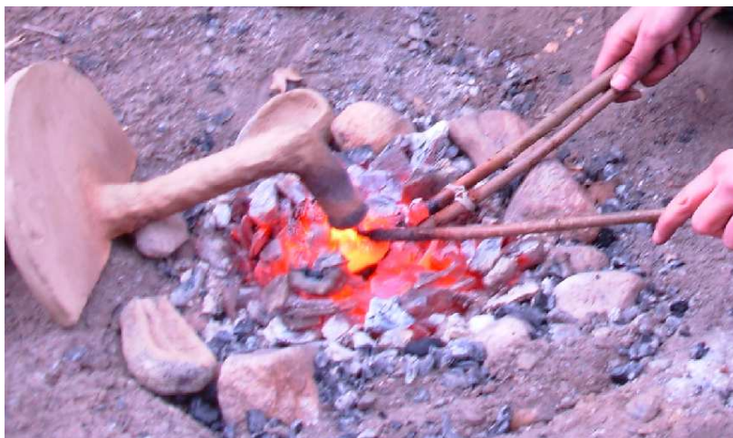
Figur 15: Härd, tuyére och tänger (foto: förf.).
