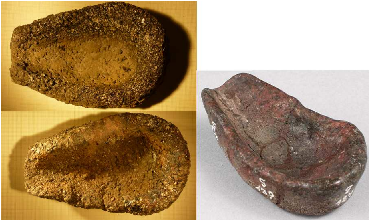
Figur 26: Tre bilder som visar hur deglarnas utseende förändras med antalet användningar. Överst till vänster; degel 3D (använd 1 gång), nederst till vänster degel 3A (använd 20 gånger), till höger; degel med inv. nr. 5859 troligen använd fler än 20 gånger. Längd resp. bredd för degel 3A & 3D: 110 mm resp. 65 mm. Längd resp. bredd för degel inv. nr. 5859: 80 mm resp. 50 mm(foto: förf.)
