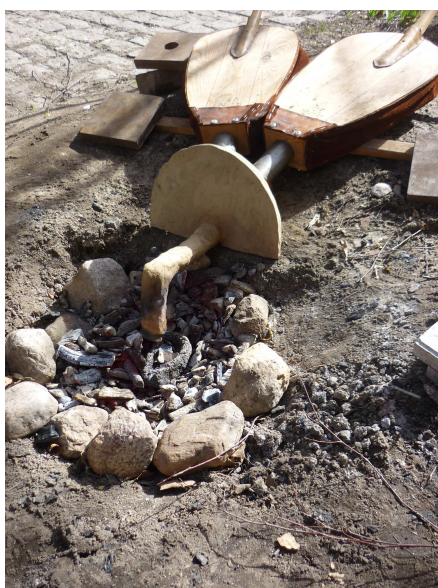
Figur 15: Härd, tuyére och tänger (foto: förf.).
