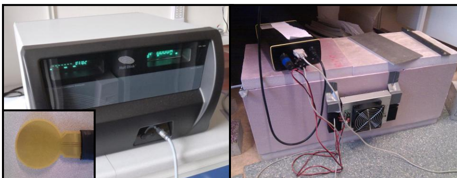
Figur 3 - HotDisk och mätsensor (vänster) samt klimatbox (höger)
