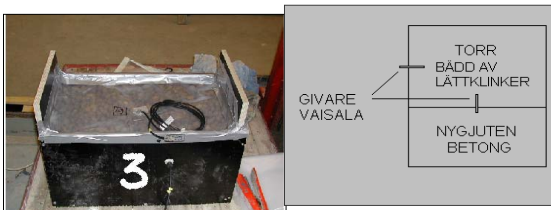
Figur 5.5. Bild av försöksupställningen samt principiell skis.
