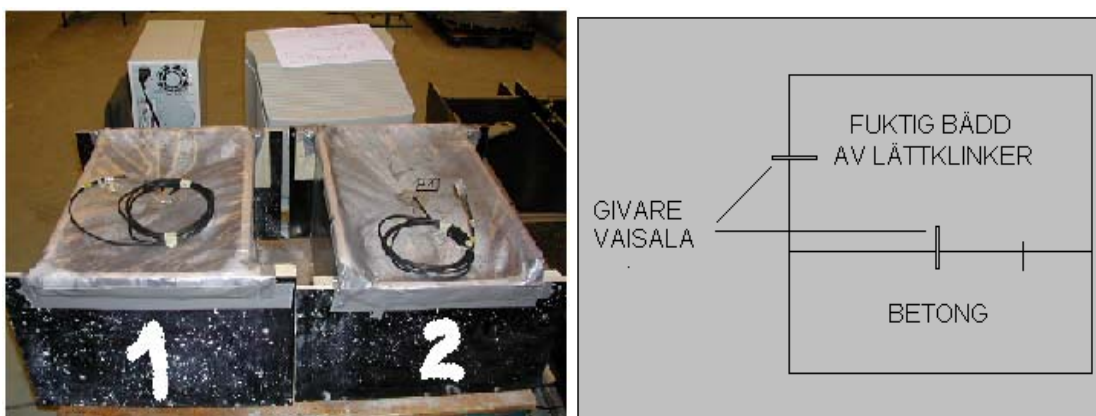
Figur 5.6. Verklig och principiell bild på försöksupställning
