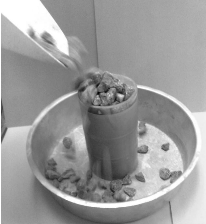
Figur 19. Lös packning. Kärlets diameter var 7,05 cm invändig höjd 13,95 cm och uträknad volym blir således 544,6 cm 3 .
