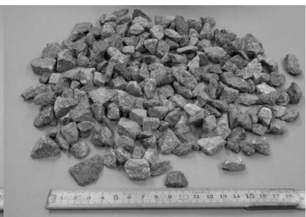
Figur 13. Krossgrus från transportbetongfabrik 1 i fraktionen 11-16 mm. Notera den stora mängden avlånga, flakiga korn med ojämna yta.
