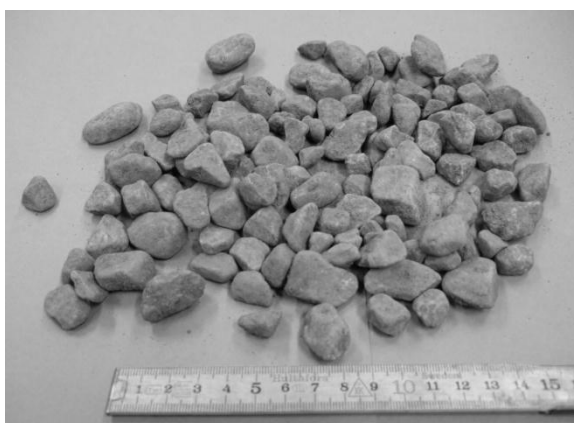
Figur 12. Naturgrus från transportbetongfabrik 3 i fraktionen 8-16 mm. Notera den stora mängden runda korn med jämn yta.
