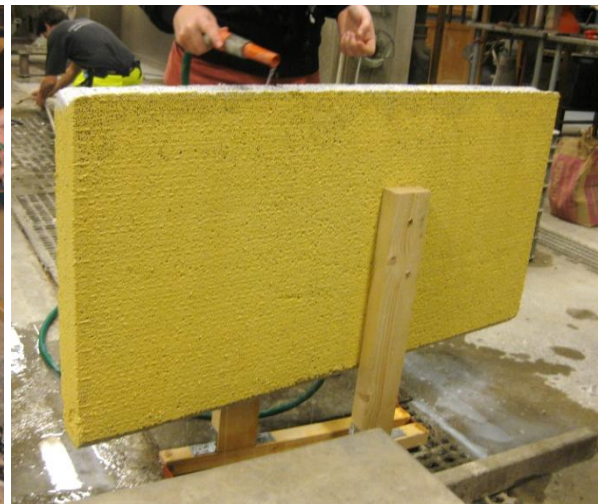
Bild 9.2 Vatten tillförs längsmed interlockskarven. Skivan är upphängd i stället.
