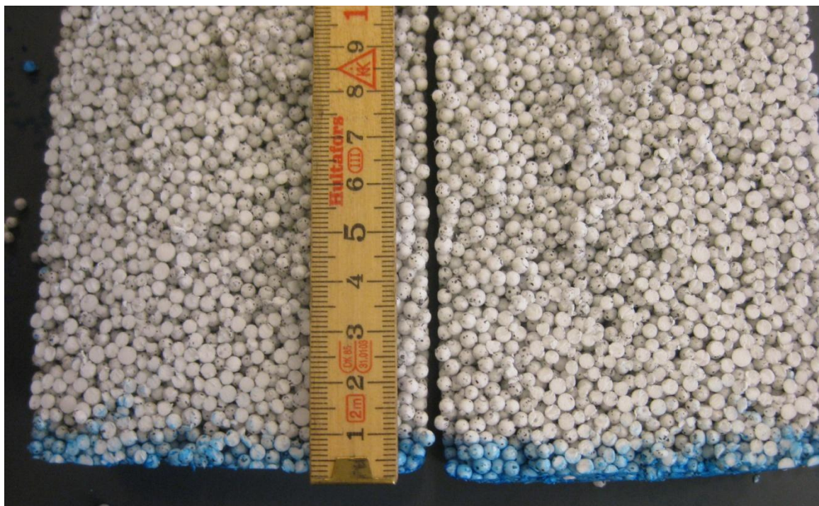
Bild 11.1 Provkropp uppskuren på mitten. Ingen kapillär stighöjd kan uppmätas.
