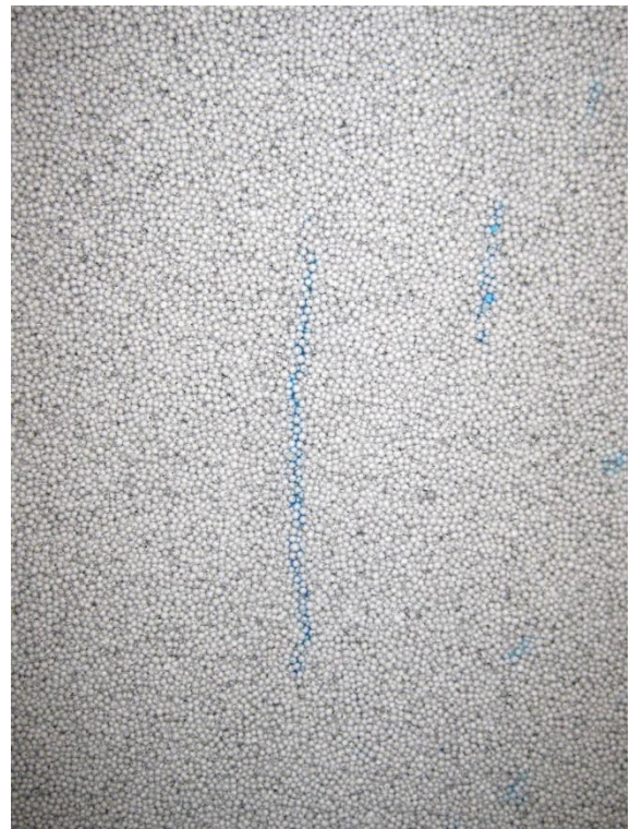
Bild 8.5 Vatten rinner precis i bakkanten på den nedersta skivan.
