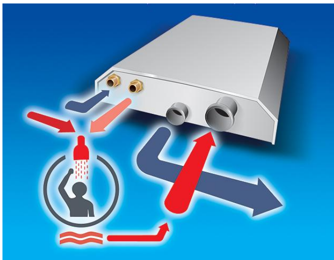
Figur 4.1 Illustration av en duschvärmeväxlare (Ekologiska Byggvaruhuset, 2011).
