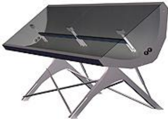
Figur 5.4 Illustration av en solcellsmodul utrustad med reflektor (Arontis, 2011).
