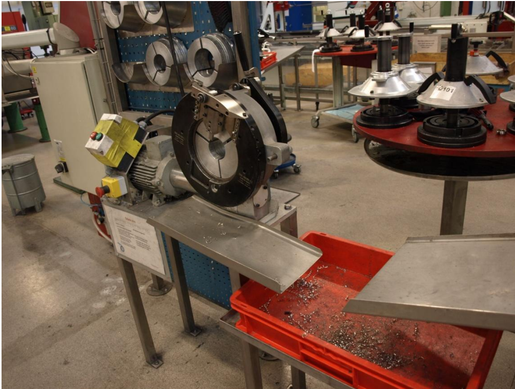
Figur 15. Bild på avstickningsmaskinen. Till höger i bilden ses även verktyg till kragningsmaskinen som är utanför bild.
