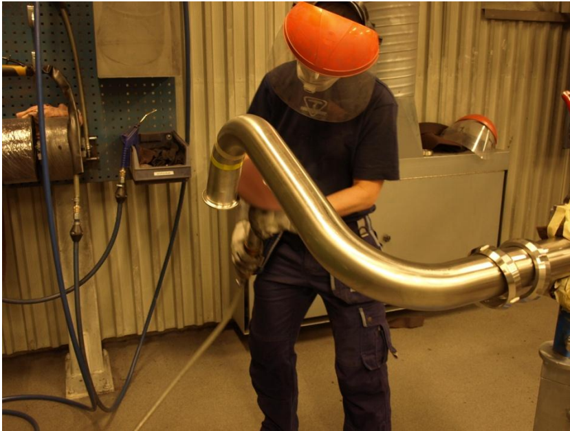
Figur 17. Bild på slipoperationen.
