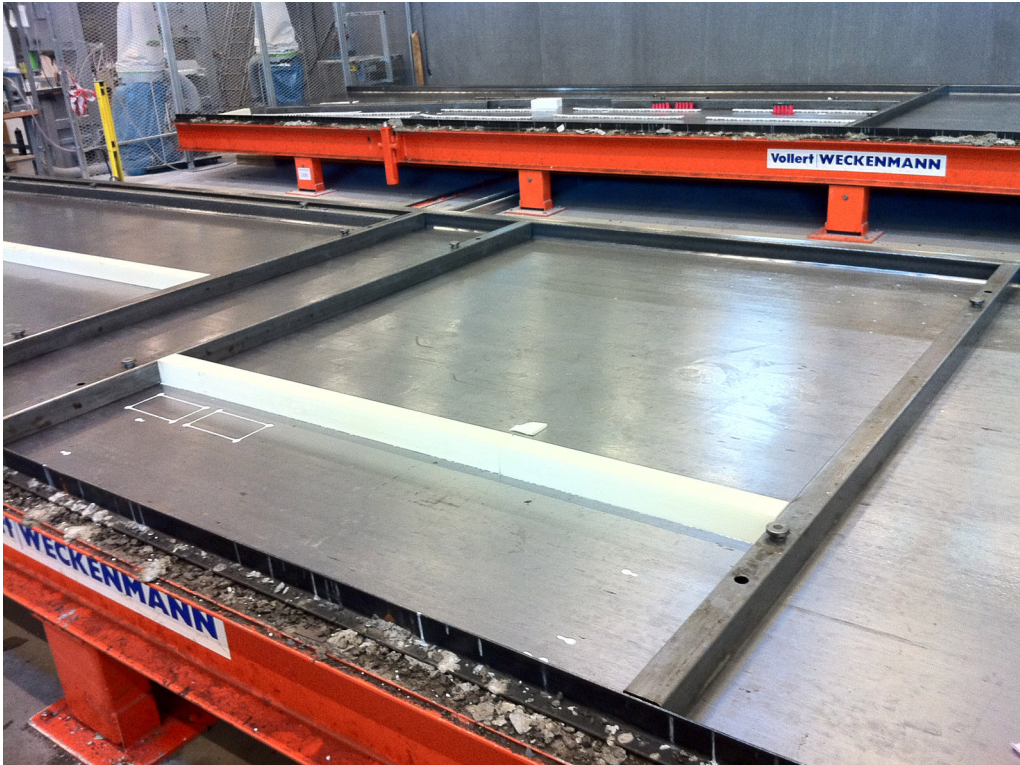
Figur 2.8 I nästa skede placeras avstängningarna ut. Här syns även markeringarna från plottningen som vita rektanglar
