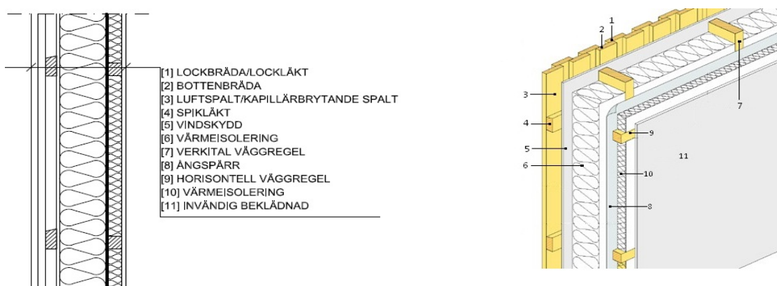
Figur 2.1. Beskrivning av tvåstegstätning. Källa: www.traguiden.se .
