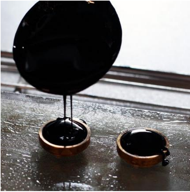
Figur 12. Upphällning av ringar till mjukpunktstester
