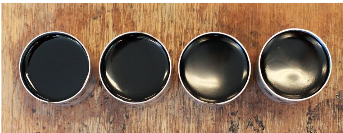
Figur 7. Burkar med 50/70-bitumen. Från vänster: 50/70, + 1, + 2, + 3. Notera skillnad i glans
