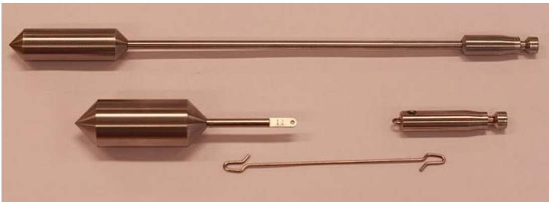
Figur 9. De två använda spindel-typerna (SC4-27 resp. SC4-21).
