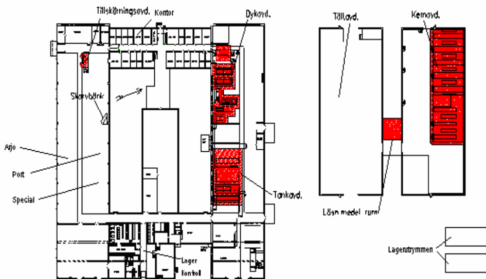
Figur 10 Fabrikslayout TPP AB. De markerade områdena är klassade. (Framework, TPP AB)
