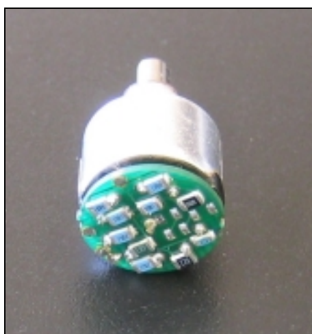
Figur 37. Kretskortet som ger omkopplaren dess karaktär.
