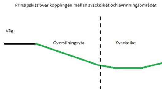
Figur 6: Principskiss (tvärsnitt) över hur avrinningsområdet hänger ihop med svackdiket.
